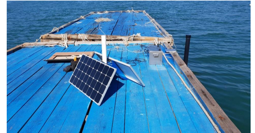
실제 해양 환경에서 테스트 중인 해양방사선 자동감시시스템
